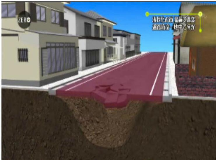
③ 夏場は路面が高温になり舗装体が剛性を失うため、自動車の通行がなくても路面の陥没が発生する。
