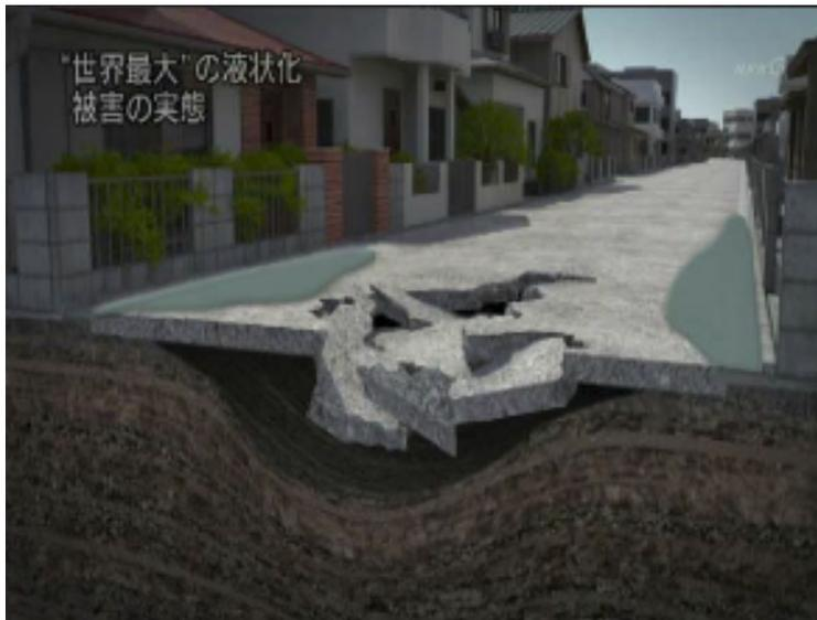
② 車輛の重量で舗装が破壊し、路面の陥没が発生する。
