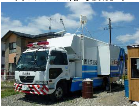
整備局から貸与されている移動通信車 写真は調査団員撮影
