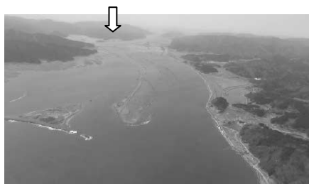
写真 1. 北上川右岸の破堤部(1) (押し波による破堤)
