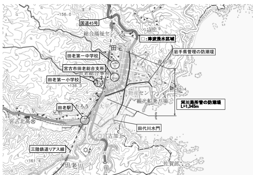
図1 宮古市田老海岸：防潮堤と浸水域
