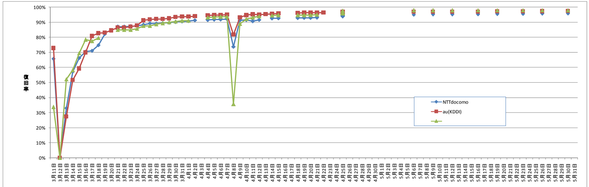
図18 「復旧率 = (最大停止局数 - 停止局数) / 最大停止局」の推移 (3月12日停止局数ベース)
